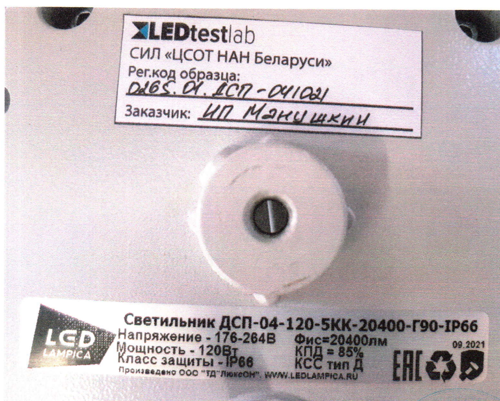
Рисунок 5 – Фотография маркировки и регистрационной этикетки образца светильник светодиодный ДСП-04-120-5КК-20400-Г90-IP66
